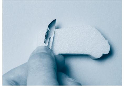
a) Ändere mit dem Styroporschneider und mit einem Skalpell deine Fahrzeugformen und teste sie so lange, bis ein optimales Strömungsbild entsteht. Dokumentiere das Endergebnis mit einem Fotohandy und klebe das Foto hier ein.
