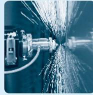
Beim **Trennen** werden größere oder kleinere Teile vom Körper abgetrennt.
