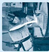
Beim **Urformen** entsteht aus flüssigem, plastischem oder pulverigem Stoff ein fester Körper.
